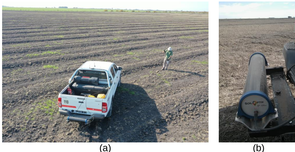
Figura 5- Relevamiento de suelos de arrocería con sensor Soil Optix. a) muestreo de suelos convencional para calibración del sensor. b) detalle del sensor y montaje para relevamiento a campo. (Jubileo, Dpto. Villaguay, Entre Ríos 2020/21)
