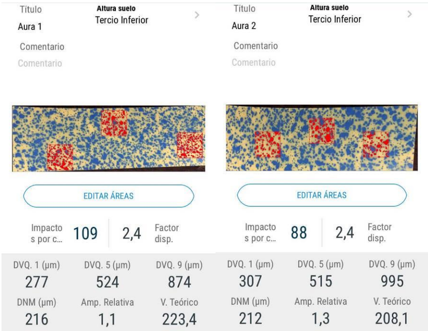
Fig. 5: Análisis de tarjetas hidrosensibles del ensayo.
