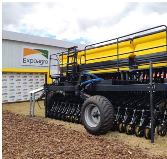
El cuerpo de siembra puede ser anclado o adosado a la estructura convencional (tolva transversal) o del tipo *Air Drill*. Consta de un sistema de triple pivoteo, que se encuentra con "patente pendiente" en los principales países productores de arroz del mundo. Este permite que cada órgano activo del cuerpo de siembra pueda copiar perfectamente las irregularidades presentes en un lote
